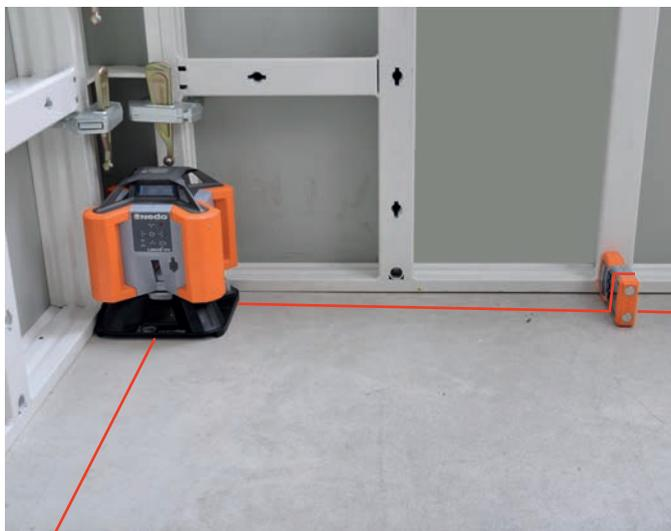
**Durchdacht.** In die Entwicklung des LINUS 1 HV sind zahlreiche innovative Ideen eingeflossen. Die Gehäuseabmessungen des Lasers und des Laserempfängers ACCEPTOR Line sind perfekt aufeinander abgestimmt. Der Abstand zwischen der senkrechten Laserebene und der Gehäusekante des LINUS 1 HV und der Abstand von der Gehäusekante zur Null-Line des Laserempfängers sind identisch.
