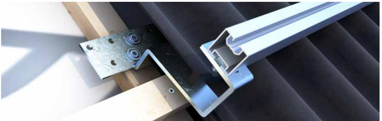
Dachhaken HEAVY an der Konterlatte montiert, durch die ausgeklinkte Dachpfanne geführt und mit montiertem Montageprofil Steildach befestigt.
