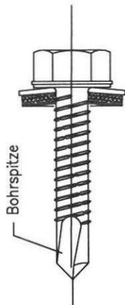
Bohrschraube mit Dichtscheibe
